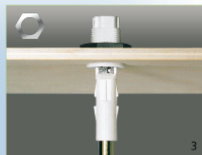
Buchse mit Sechskantmutter M 16 x 1 und Leitung 100 mm + AMP-Stecker. Materialdicke max. 13 mm. hexagon nuts and bush with cable 100 mm and AMP-plug
